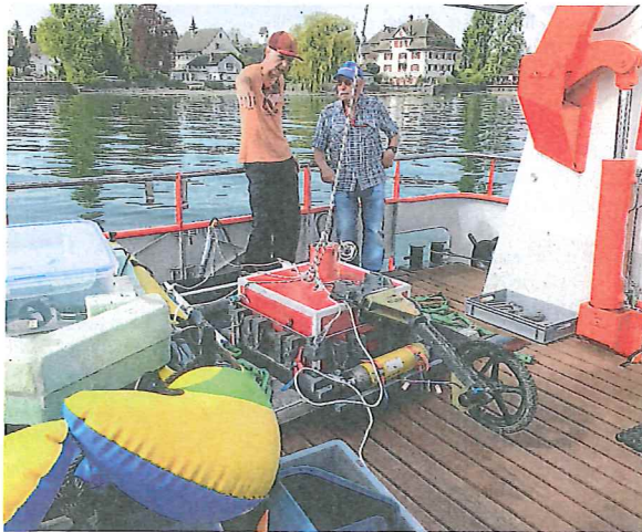
Weltweit einzigartiger Prototyp eines Unterwasser-Georadar-Geräts der Technischen Universität Darmstadt, links der Sedimentologe Jens Hornung.
