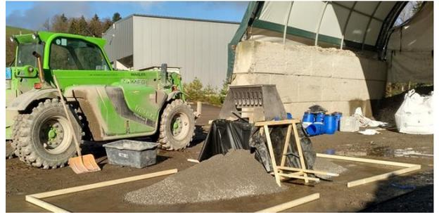
Abbildung 2: Teilung und Reduktion der jeweiligen mineralischen Restfraktionen zur Laborprobe A und B.
