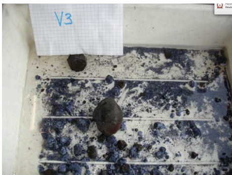
Die Probestücke von V3 nach 287 erreichten Durchschlägen. Das Korund- Diasporstück ist völlig in kleine Stücke zerbrochen, während das chloritoidhaltige Stück praktisch unversehrt blieb.
