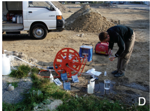
Grundwasser Probenahme vom 16.10.2007 mit den nötigen Pump- und Messgeräten.
