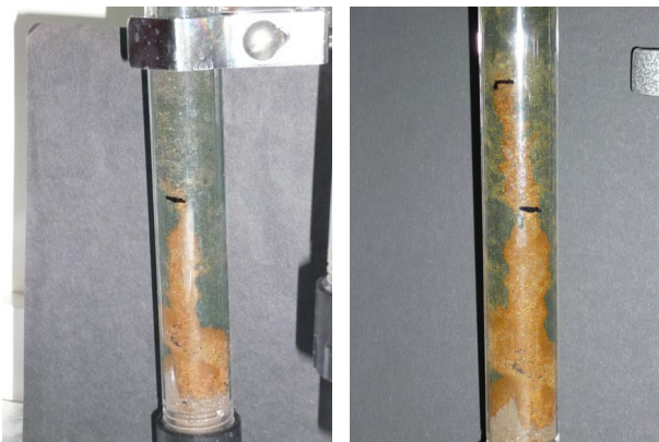
Fotos der Säule 13+1% OM am 13.12.06 (125 Porenvolumen) links, sowie am 1.3.07 (250 Porenvolumen) rechts. Deutlich zu sehen ist, dass der scharfe Übergang zwischen der grünen und rot-braunen Verfärbung deutlich nach oben gewandert ist.
