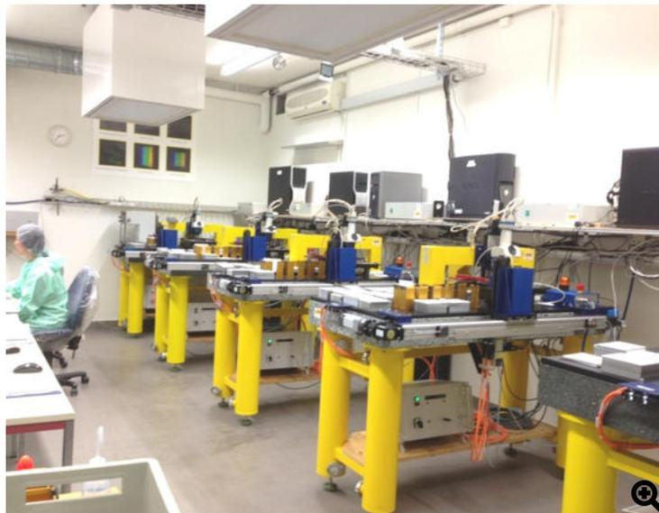
Mikroskope, die zum Scannen der Filme am Laboratorium für Hochenergiephysik (LHEP) in Bern eingesetzt werden.
