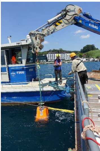
Abb. 7 Absenken eines Ozeanboden Seismometers. Ein dGPS wird dazu benutzt, die Koordinaten des Ozeanboden Seismometers zu registrieren. ©Schweizerischer Erdbebendienst an der ETH Zürich 2018
