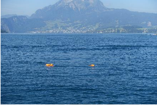
Abb. 17 Seismometer und Boje schwimmen an der Wasseroberfläche bereit zum Hochholen auf die Plattform. ©Schweizerischer Erdbebendienst an der ETH Zürich 2018
