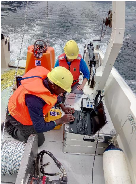
Abb. 10 Das Seismometer wird wieder für die neue Messphase programmiert. ©Schweizerischer Erdbebendienst an der ETH Zürich 2018
