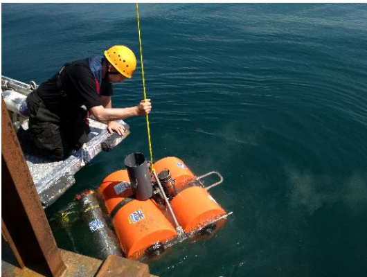
Abb. 4 Nach 6 Wochen Messungen auf dem Seeboden werden die Seismometer wieder auf die Plattform gehoben. ©Schweizerischer Erdbebendienst an der ETH Zürich 2018
